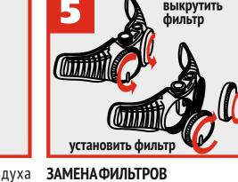
В БПВ применен комплект из двух противоаэрозольных фильтров Р R При работе оба фильтра всегда должны быть установлены в БПВ, после установки необходимо проверить соединение фильтров с БПВ, оно должно быть прочным и
